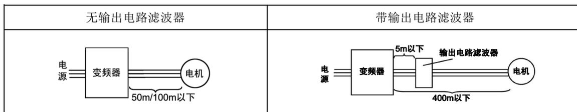
带输出电路滤波器时，请使用 100m 以下（V/f 控制时在 400m 以内）的总配线长度。
